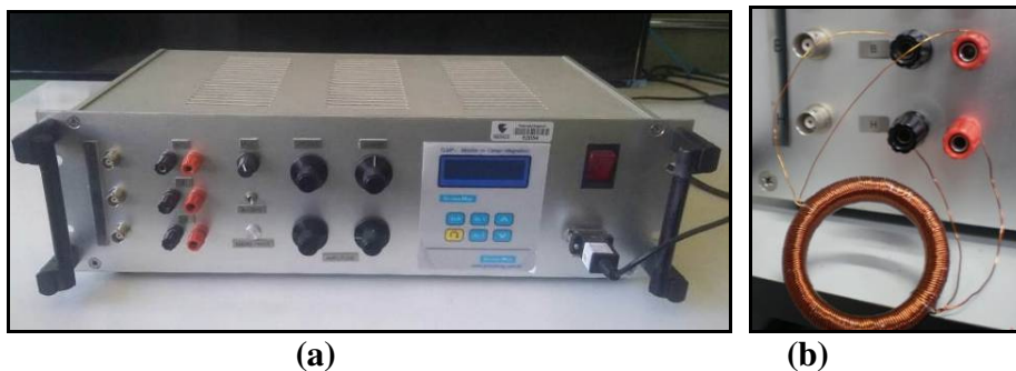
Figura 48 – Traçador de Curvas Magnéticas – (a) Modelo TLMP-TCH-14 – (b) Conectado ao anel bobinado
