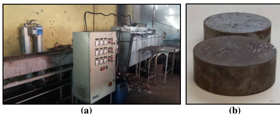
Figura 54 – Sinterização dos blocos do rotor – (a) Forno de esteira – (b) Bloco sinterizado
