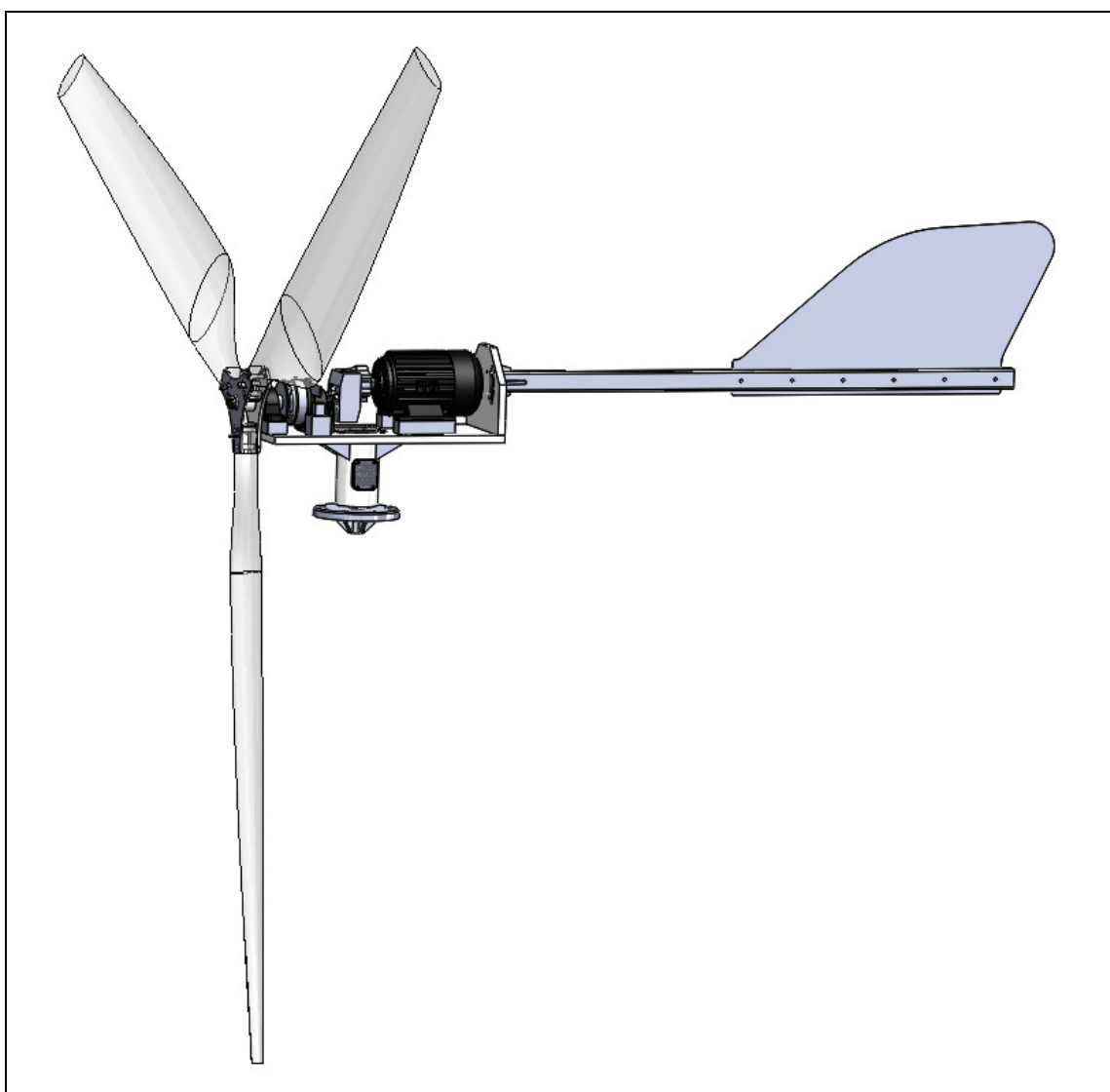
Figura 65 – Vista Estrutural interna do Aerogerador
