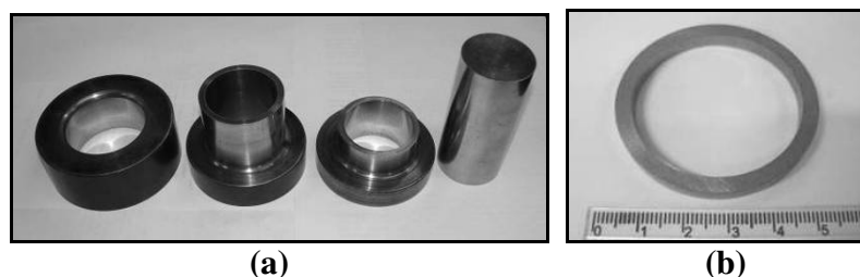
Figura 43 – Amostras na forma de anel – (a) Matriz – (b) Corpo de Prova
