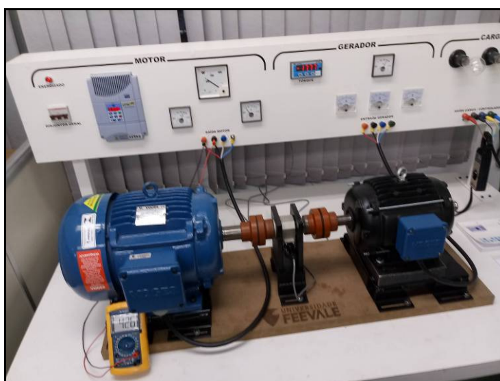
Figura 64 – Máquina Síncrona Trifásica do Aerogerador na Bancada de Ensaios
